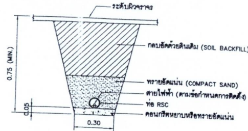
รายละเอียดการเดินสายไฟฟ้าใต้ผิวจราจร มาตราส่วน 1:20
